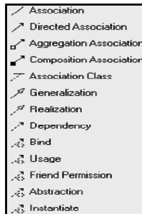
Figura 41. Líneas para unir artefactos utilizadas en un diagrama de clases en XDE
