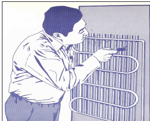
Figura 38. Limpieza del condensador.
