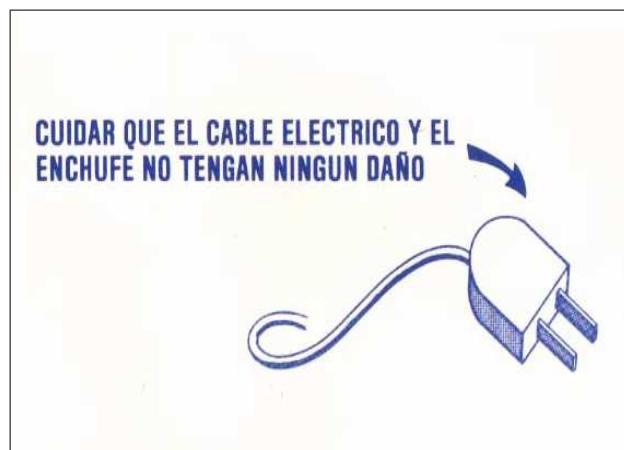
Figura 32. Revisión de la espiga eléctrica.
