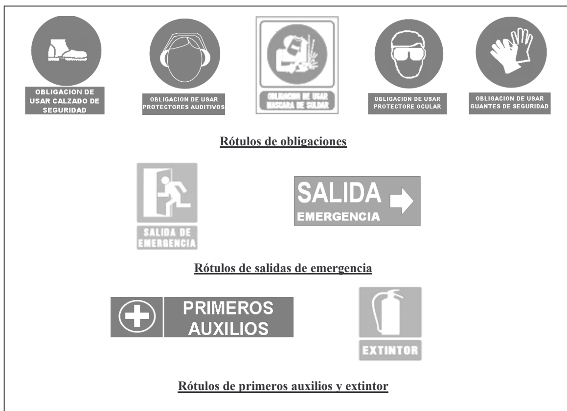
Figura 12 Rótulos que se emplean en señalización industrial
