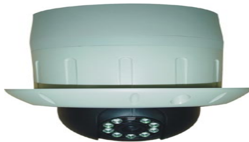
Figura 29. Cámara IP con sensor de Movimiento.
