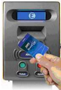
Figura 11. Lector de tarjetas de proximidad
