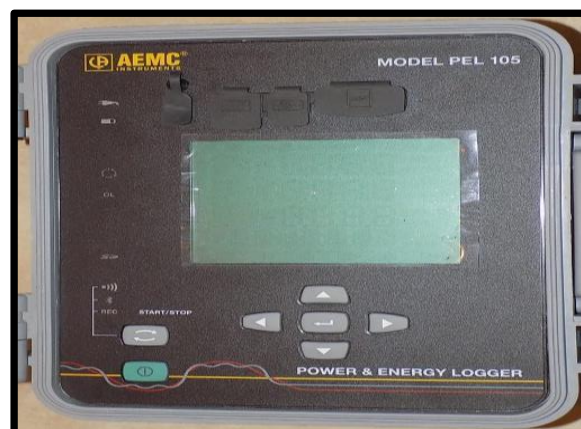
Figura 38. Registrador de redes, marca AEMC, modelo PEL 105
