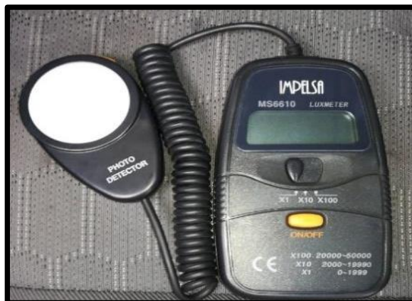
Figura 39. Luxómetro, marca IMPELSA, modelo 6610
