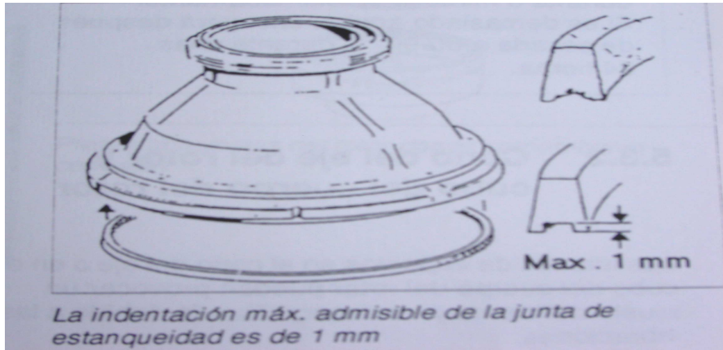
Figura 23. Junta de estanqueidad de la tapa del rotor
