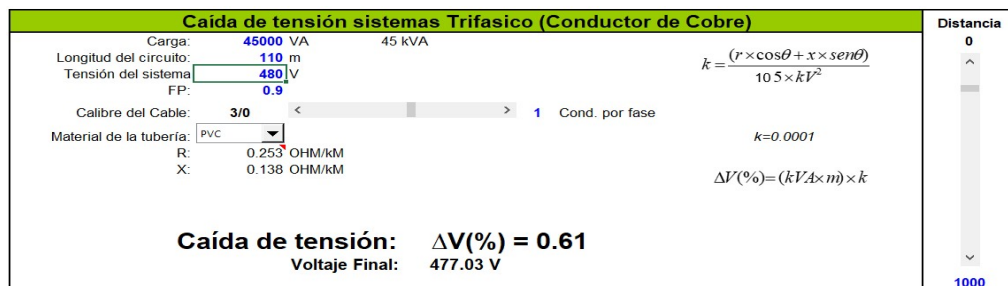
Figura 142. Caída de tensión alimentación cuarto eléctrico 2
