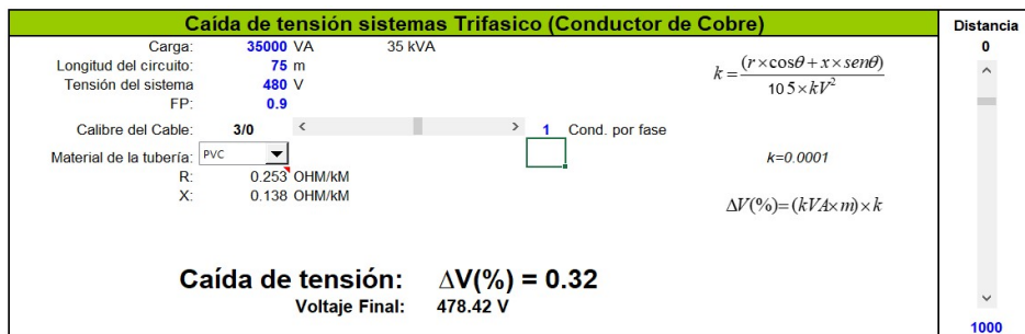
Figura 141. Caída de tensión alimentación cuarto eléctrico 1
