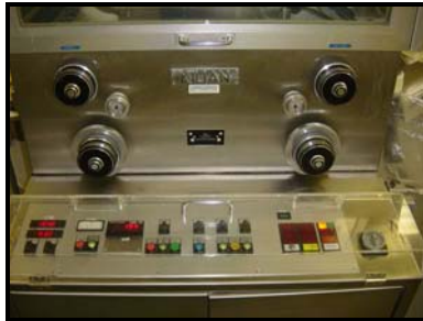
Figura 12. Tablero de controles y volantes de ajuste.
