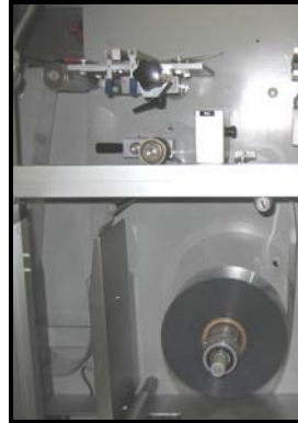
Figura 45. Porta bobina de material termo formable.
