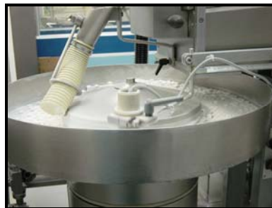
Figura 41. Depósito de alimentación vibrador.
