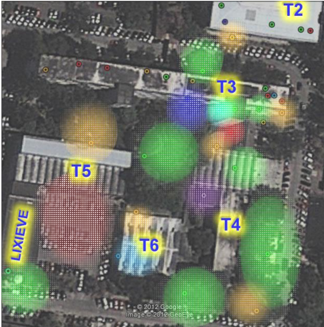
Figura 76. Distribución actual de canales. Edificios T3, T4, T5, T6: exteriores.
