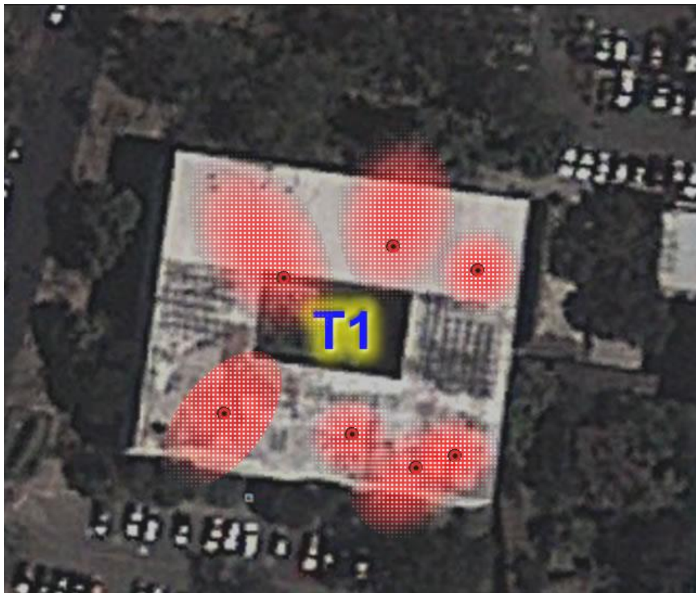
Figura 81. Cobertura completa con nuevas redes. Edificio T1, 1 er nivel
