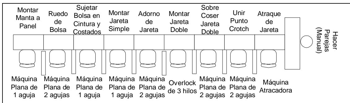
Figura10. Disposición de estaciones para la costura de la parte delantera de un pantalón
