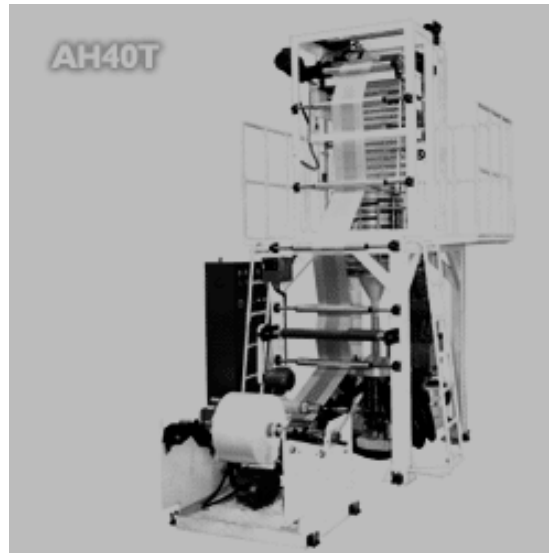
Figura 4. Proceso de extrusión de película plástica
