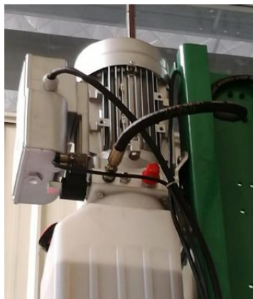
Figura 12. Bomba hidráulica de elevador de dos plazas para automóviles
