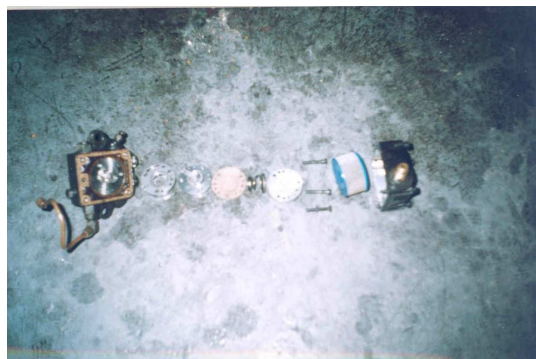
Figura 18. Mantenimiento de las bombas de combustible
