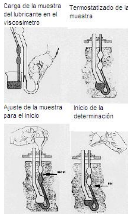
Figura 3. Determinación de viscosidad cinemática de lubricantes
