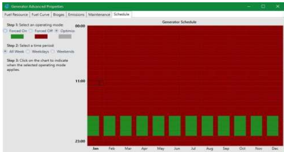
Figura 33. Horario del generador diésel en simulación HOMER
