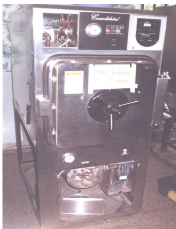
Figura 7. Autoclave eléctrico o de vapor autogenerado
