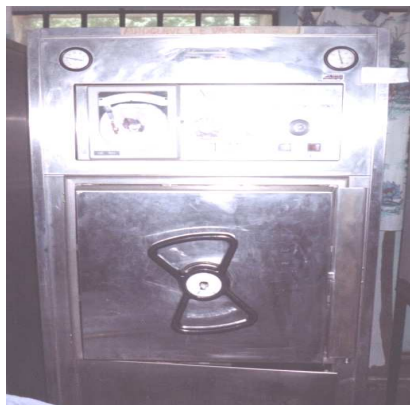
Figura 6. Autoclave de vapor generado por caldera o vapor central
