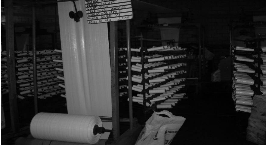
Figura 4. Conos de hilo colocados en las filetas de las lanzaderas
