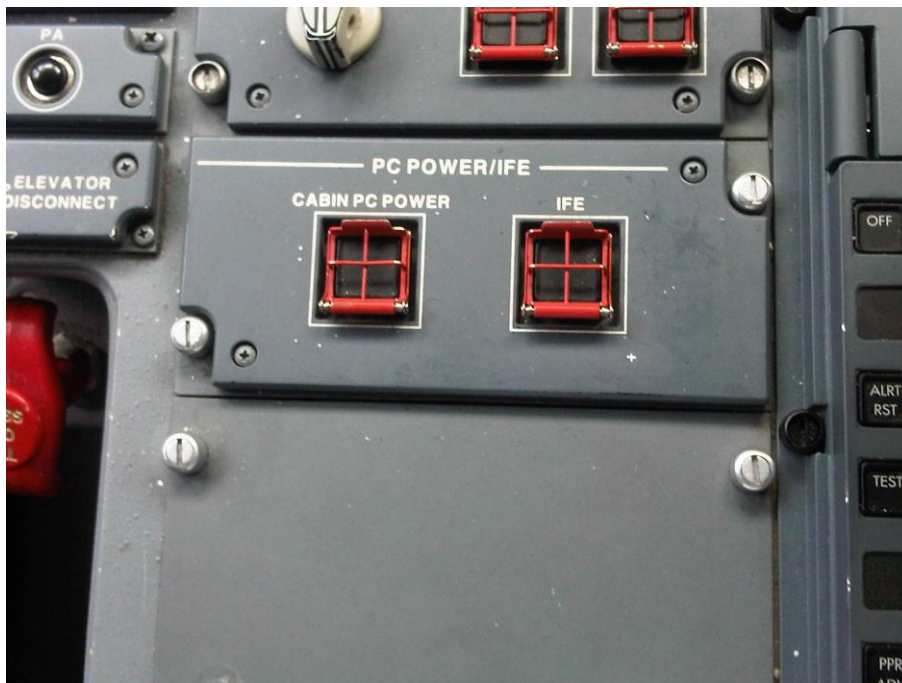
Figura 33. Panel de energía Sistema IFE
