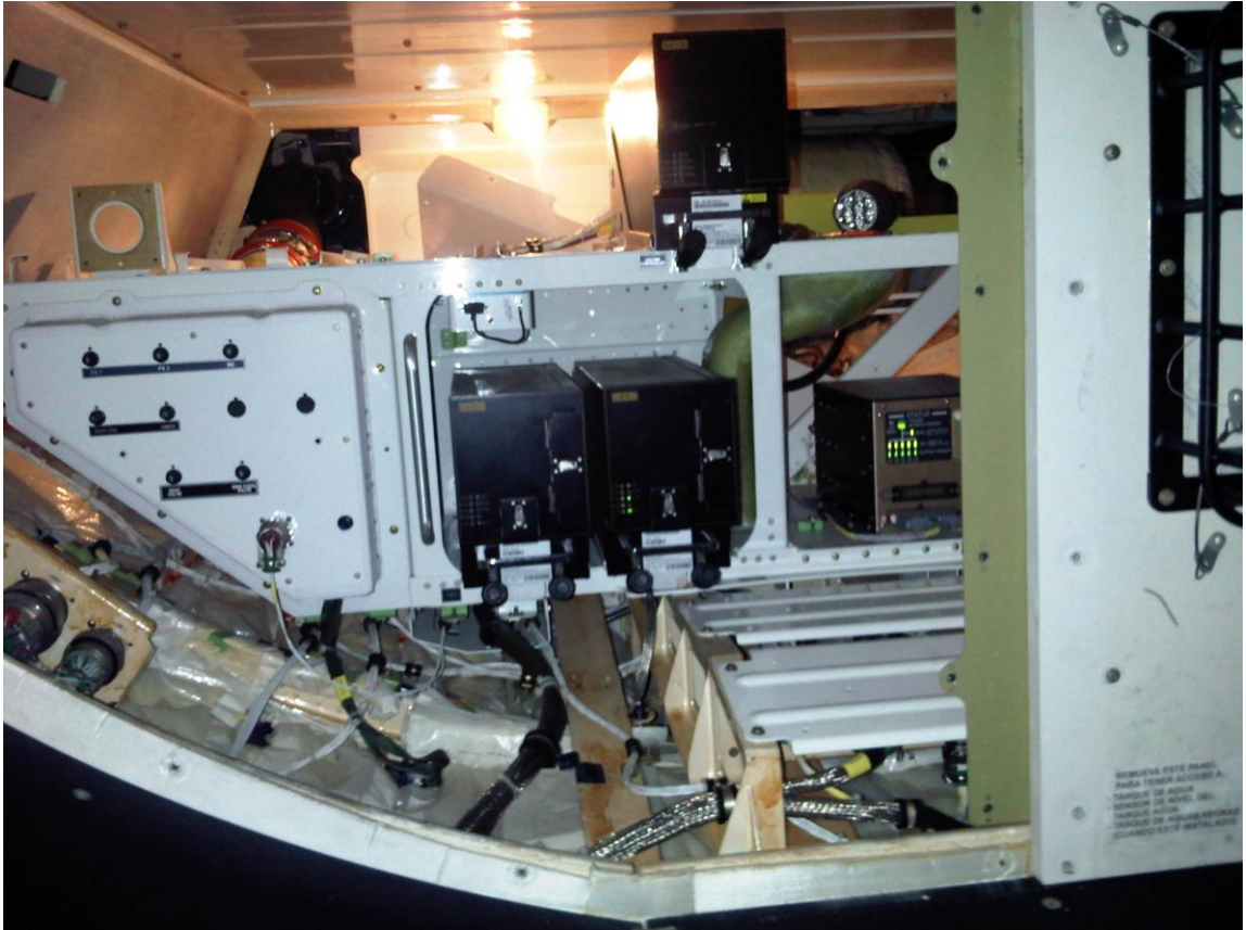
Figura 5. Unidades removibles en línea de mantenimiento
