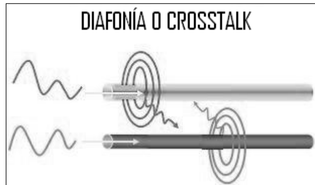
Figura 20. Diafonía entre dos líneas de transmisión
