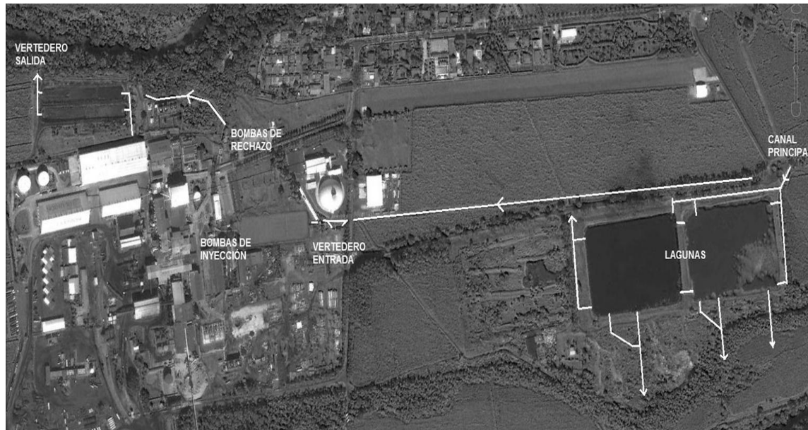
Figura 48. Vista de planta del circuito de agua
