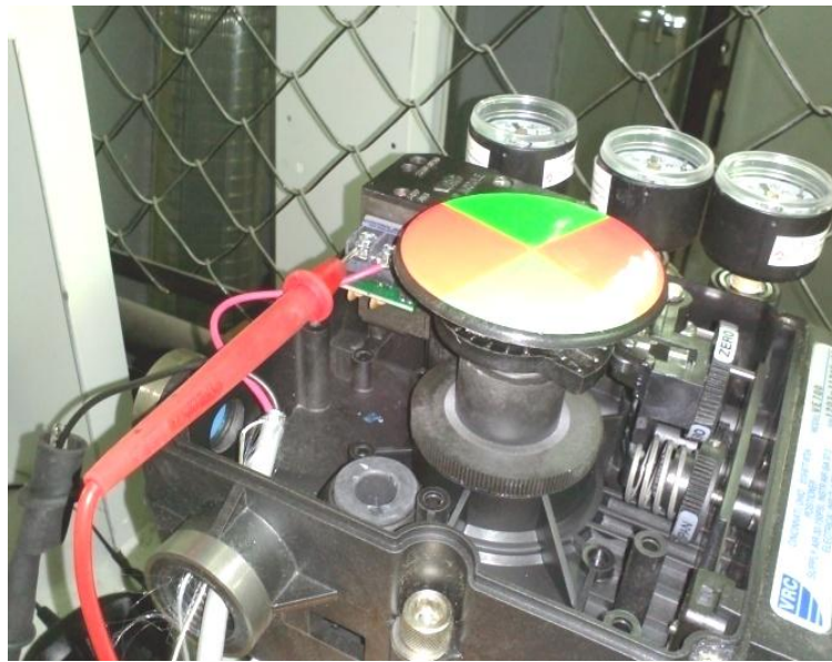
Figura 113. Ajustando la servo válvula
