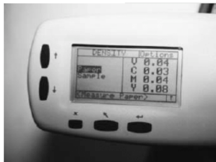
Figura 103. Espectrodensitómetro leyendo el color del papel.
