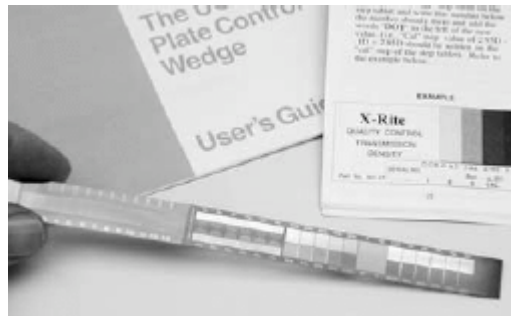
Figura 110. Película de calibración para densitómetro de transmisión.
