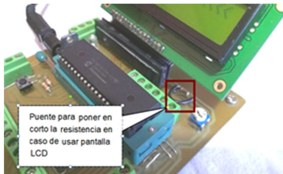
Figura 37. Conexión LCD, resistencia en corto
