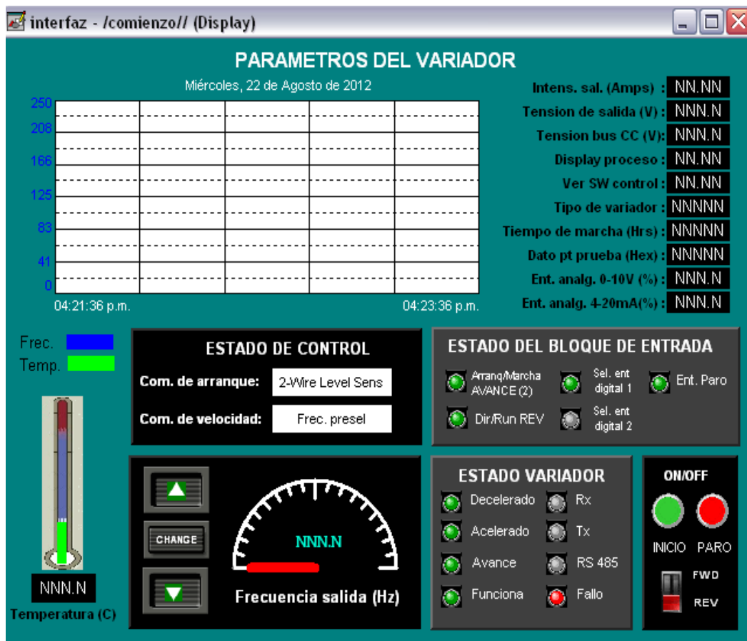
Figura 36. Interfaz del variador de frecuencia
