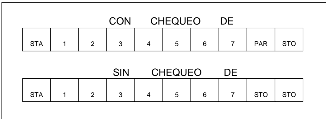
Figura 32. Orden de bits (ASCII)
