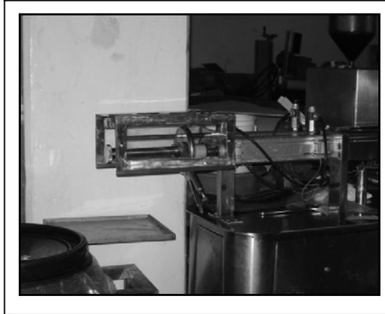
Las tapas son abatibles sobre un marco en acero inoxidable, cuenta con partes en acrílico para mayor visibilidad de la carrera de los émbolos, son livianas y se pueden desmontar completas con el marco de la base del equipo, para una reparación o mantenimiento mayor.
