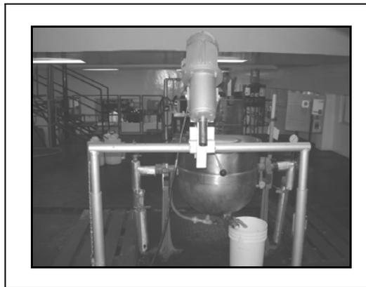
Marco de los agitadores no tienen paro de emergencia, que los hace inseguros en su operación, el eje del agitador funciona en revoluciones altas y puede atrapar prendas de vestir o redes para el cabello y lesionar al operario.
