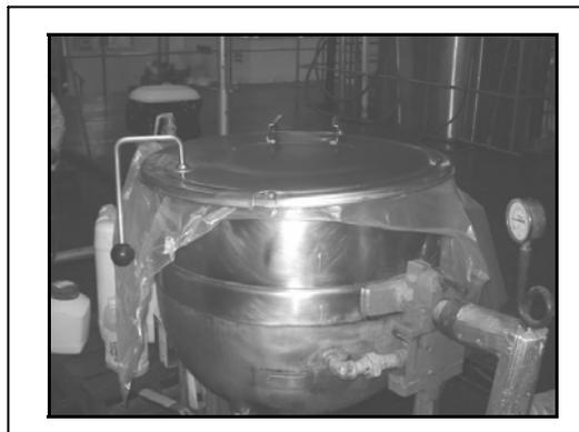
La tapa puede manipularse fácilmente por que cuentan con una bisagra y sin riesgo de quemaduras por que el extremo del agarrador es de un material que no absorbe tanto el calor, también se aumentó la higiene del proceso con la implementación de las tapas.
