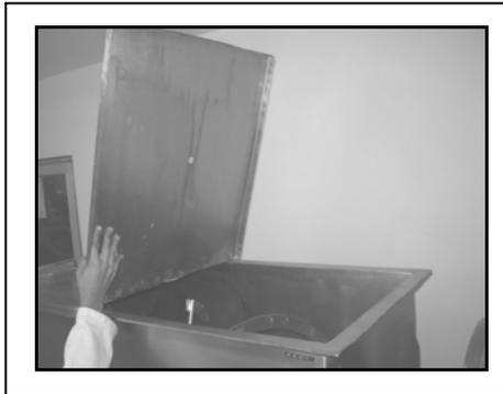
Tapa de la tolva en malas condiciones, no tiene orejas para abrir y cerrar la tapa, el equipo no cuenta con micro interruptores eléctricos para desactivarlo y así eliminar el riesgo de atrapamiento por las aspas que realizan la mezcla.
