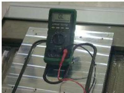
**27 / 11 / 2002:** la resistencia dañada se sacó de la placa de precalentamiento. Se recibió, probó e instaló en la placa de la unidad de precalentamiento la resistencia solicitada. La placa fue instalada otra vez usando las cuerdas atadas a la grúa hidráulica. La resistencia trabajó bien, y alcanzó la temperatura deseada. Este procedimiento se observa en la figura 35:
