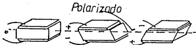
Figura 1. Acción de corte en las placas cerámicas de un transductor Piezoeléctrico. (Ref. 3, Pag. 108)
