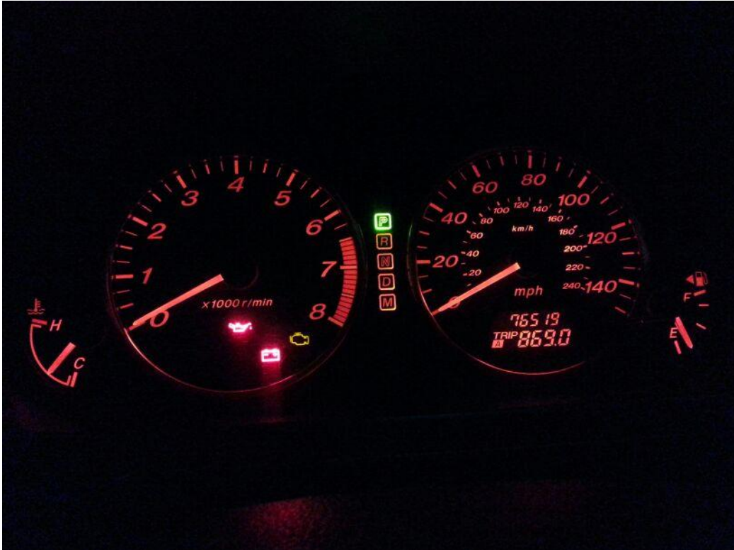
Figura 22. Luz de mil encendida en Mazda 6 V6 3.0L 2006
