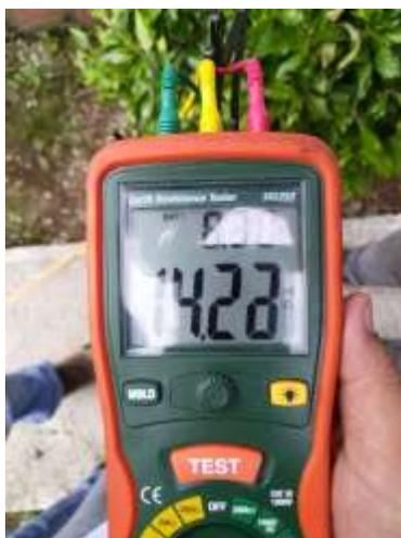
*Nota.* Medición de la puesta a tierra de la estación INSIVUMEH GT. Elaboración propia, realizado con Paint.
