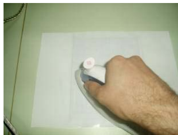
Figura 42. Transferir el negativo al cobre
