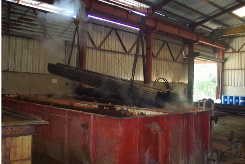
Figura 1. Limpieza de tubos de acero con soda cáustica
