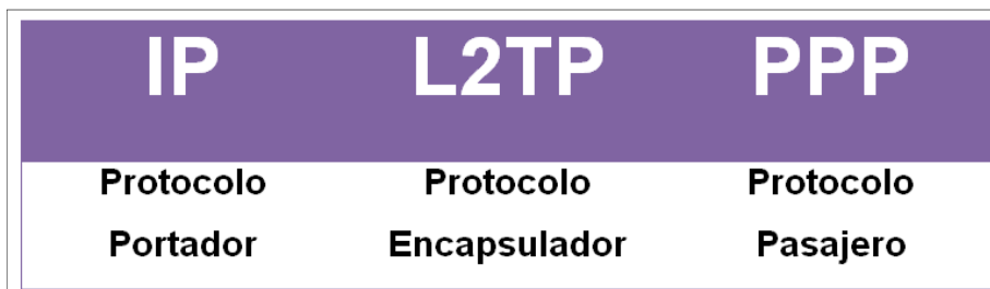
Figura 7. Estructura de paquete tunneling
