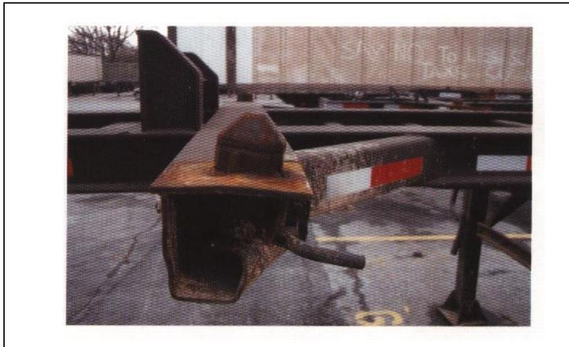
Probar operación de twist lock por atadura o torcedura y localización correcta del cono, verificar que de su vuelta de apriete correctamente.
