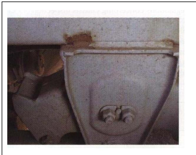
Grieta o fisura en soldadura de cargador central, soldar nuevamente
