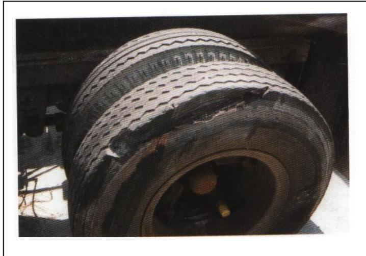
Severo corte en banda de rodadura, carcasa dañada, cambiar llanta
