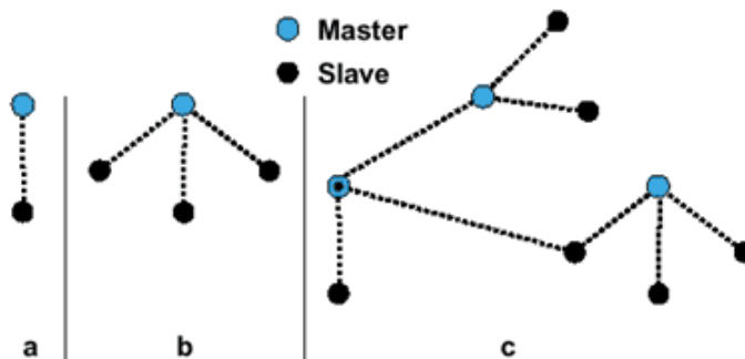
Figura 15. Organización de la arquitectura de Bluetooth, (a) Piconet con un solo esclavo, (b) con múltiples esclavos, (c) scatternet.
