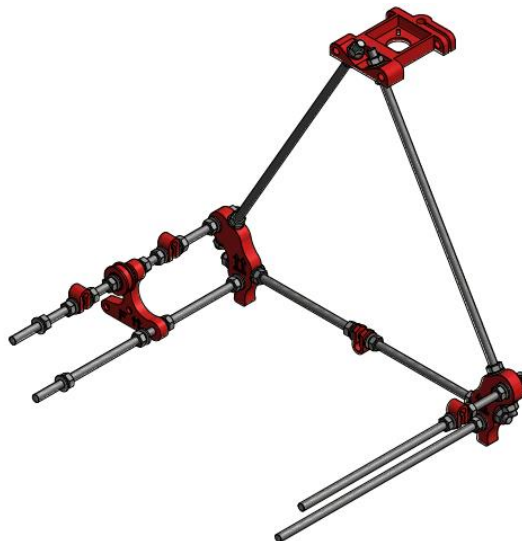
Figura 57. Paso 18 – montaje de chasis básico
