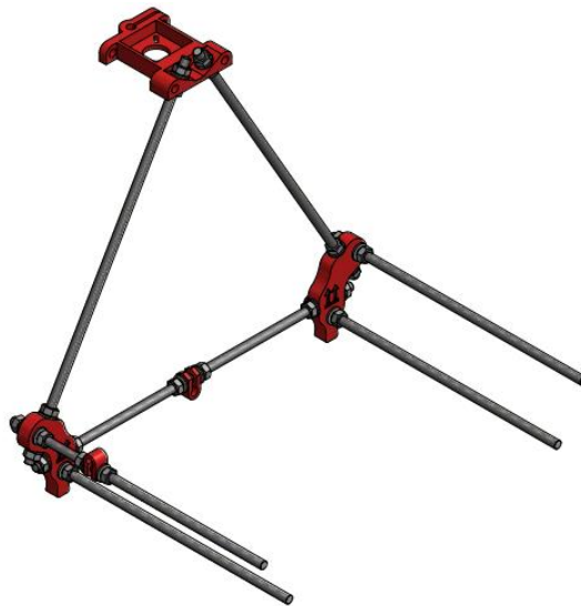
Figura 48. Paso 11 – montaje de chasis básico
