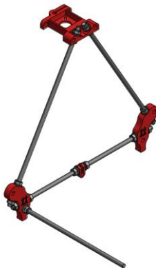
Figura 45. Paso 9 – montaje de chasis básico
