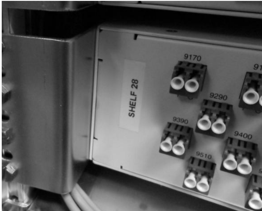
Figura 33. Interfaces ópticas sin uso con protector contra polvo
