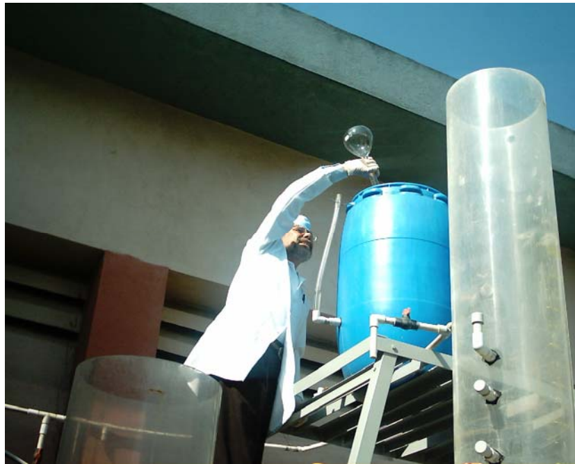
Figura 9. Agitación del agua conteniendo el As durante tres períodos de 5 minutos cada uno.
