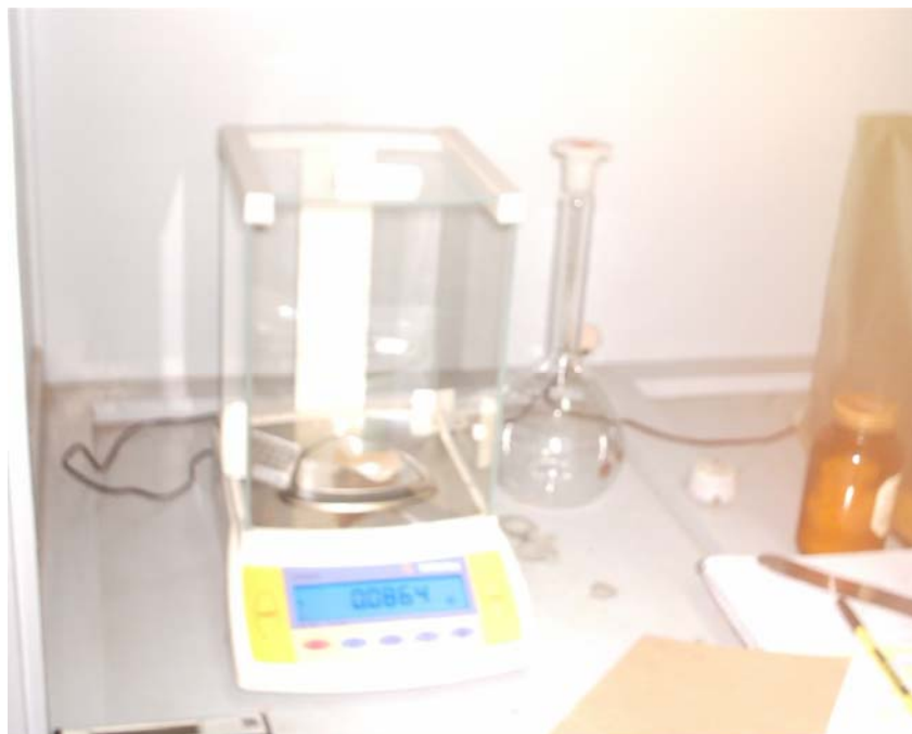
Figura 6. Momentos en que se pesan los 0.0864g de Arsenito de Sodio en la balanza analítica.
