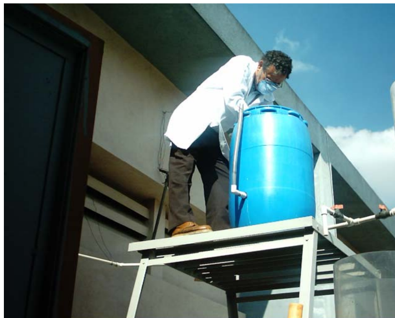
Figura 9. Agitación del agua conteniendo el As durante tres períodos de 5 minutos cada uno.
