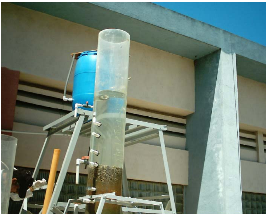
Figura 3. El Filtro N° 1 con 50 litros de agua con arsénico.
