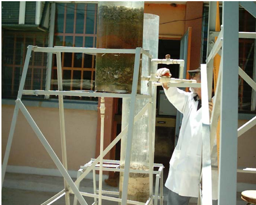
Figura 5. Vista del momento en que se descarga el Filtro N°1 en el Filtro N°2.
