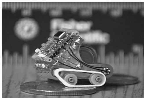
Figura 33. Robot móvil creado con tecnología MEMS, incluye motor, control y su fuente de poder
