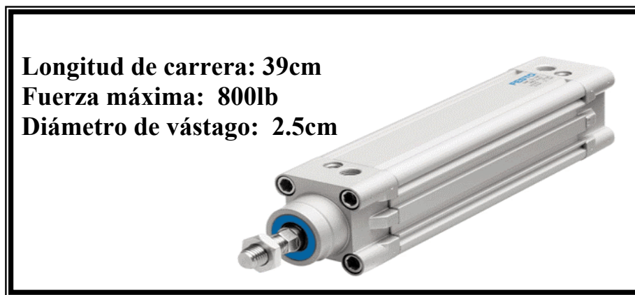
Figura 31. Cilindro de doble efecto
