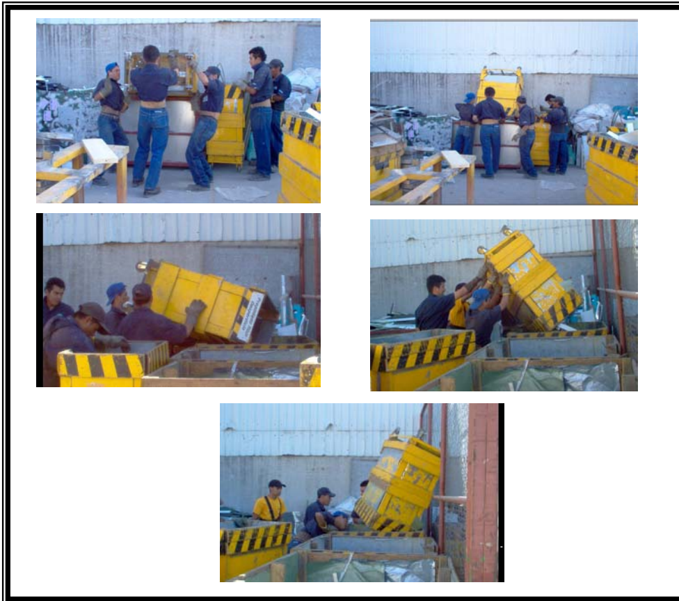
Figura 19. Descarga de chatarra de forma manual
