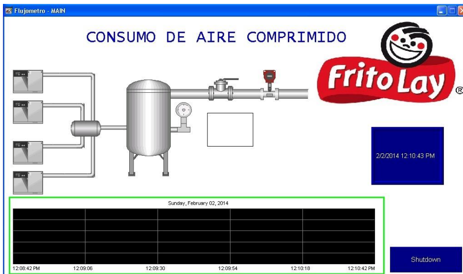
Figura 35. Panel de visualización del sistema de aire comprimido
