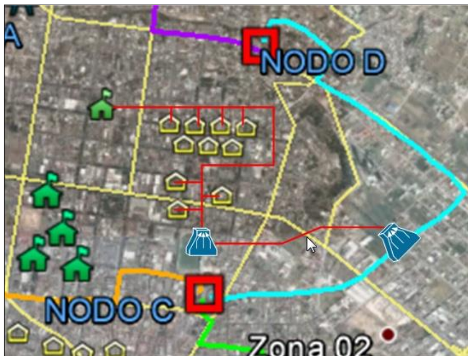
Figura 56. Distribución GPON entre nodo C y D
