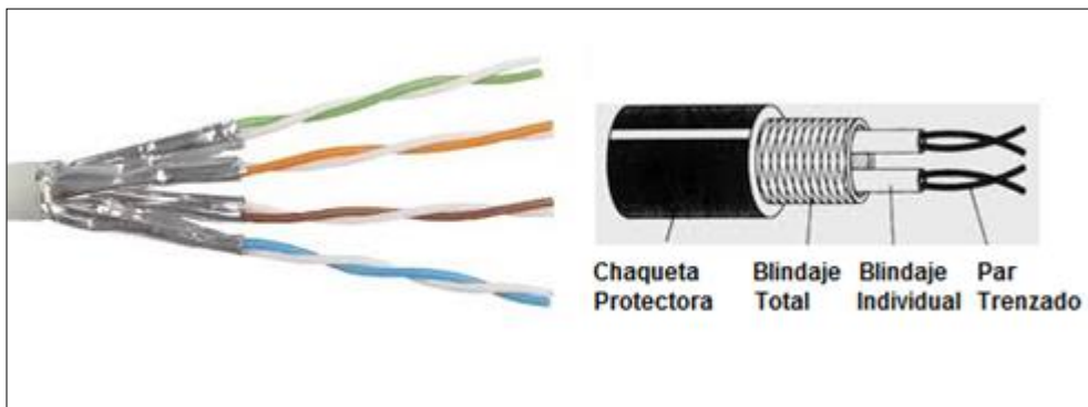
Figura 8. Cable STP y su construcción
