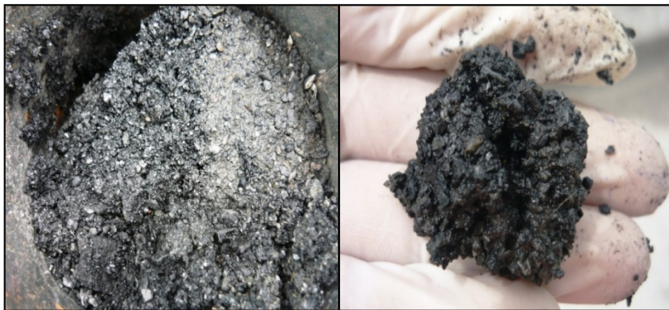
Figura 16: Presencia de lodos digeridos en la caja entrada al humedal
