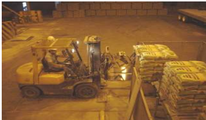
Figura 6. Despacho del cemento en montacargas con aditamento push-pull
