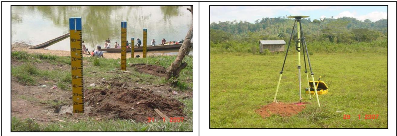
**Fotografía 8.** Estación hidrométrica convencional (limnimétricas), construcción y geoposicionamiento de un BM, Nicaragua, cuenca del río Wawa (Fuente INETER)
