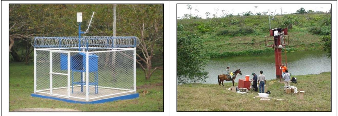
**Fotografía 7.** Estaciones hidropiuviométricas instaladas en Nicaragua, cuenca del río Escondido
