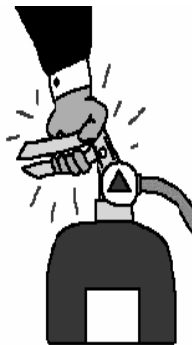
Figura 39. Liberación del agente extintor
