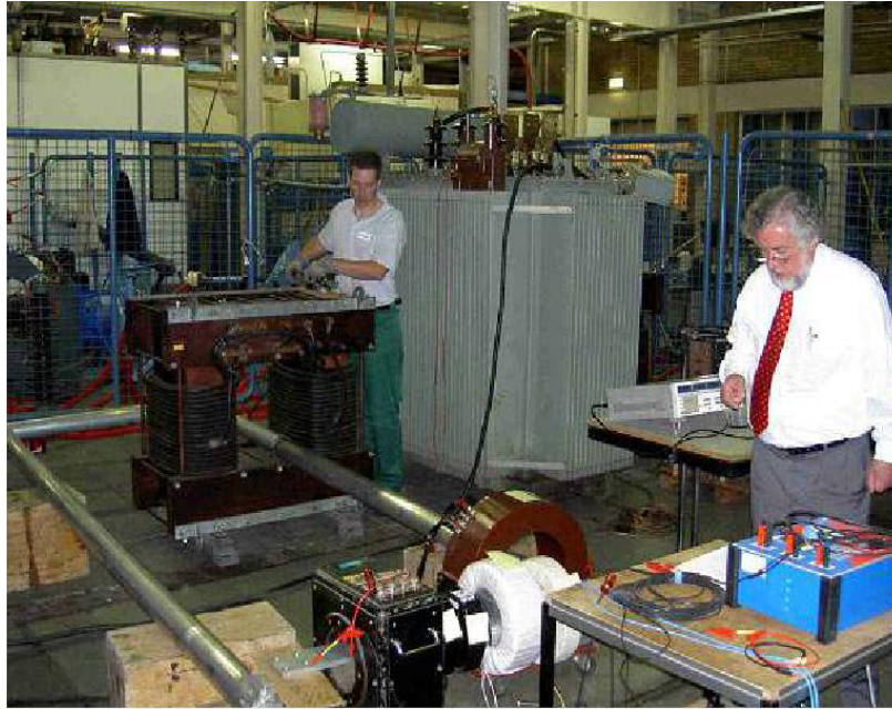
Figura 18. Prueba de determinación de curva de magnetización con corrientes nominales
