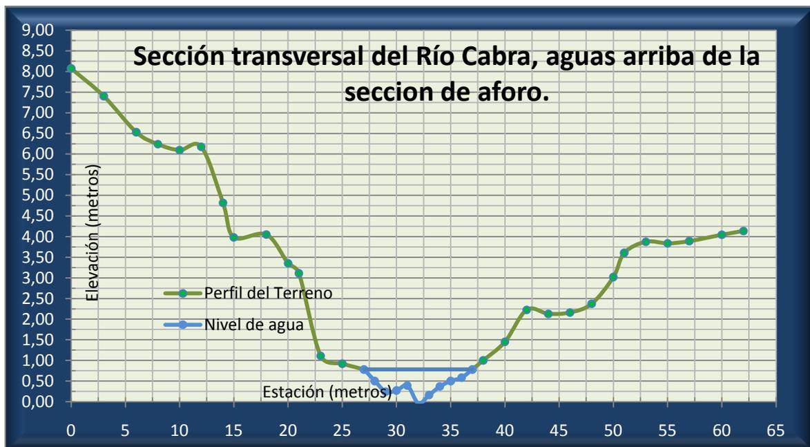
**Figura 5. 1** Sección transversal del Río Cabra, aproximadamente 30 metros aguas arriba de la sección de aforo. Fuente: Levantamiento en campo por personal de la Gerencia de Hidrometeorología de ETESA, Panamá.
