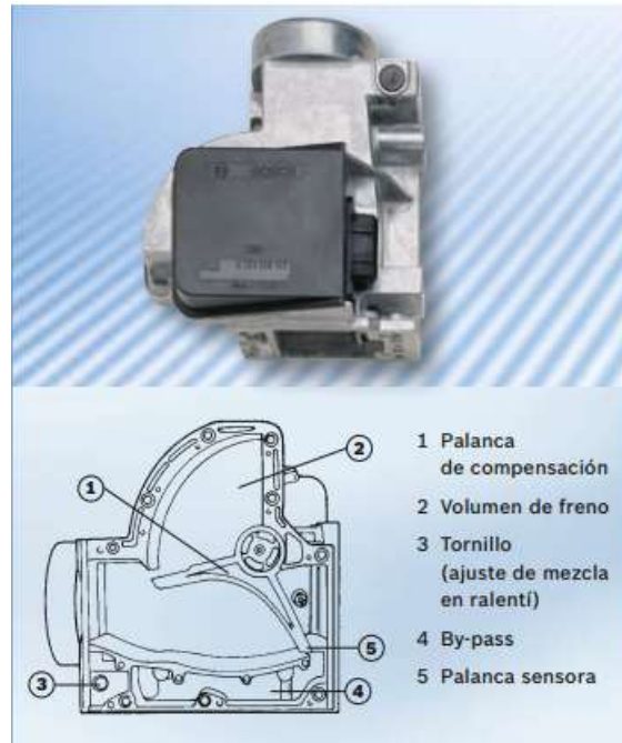
Figura 4. Medidor de flujo de aire
