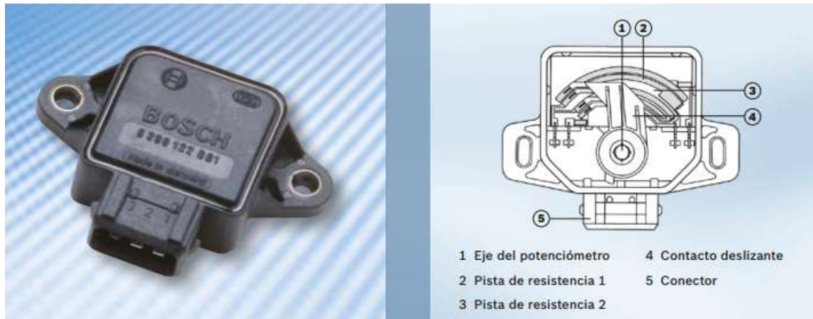
Figura 7. Potenciómetro de la mariposa
