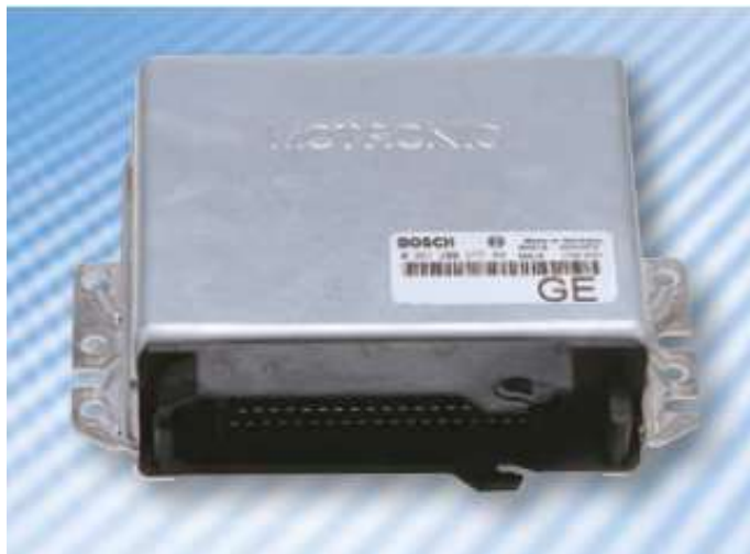
Figura 3. Unidad de control
