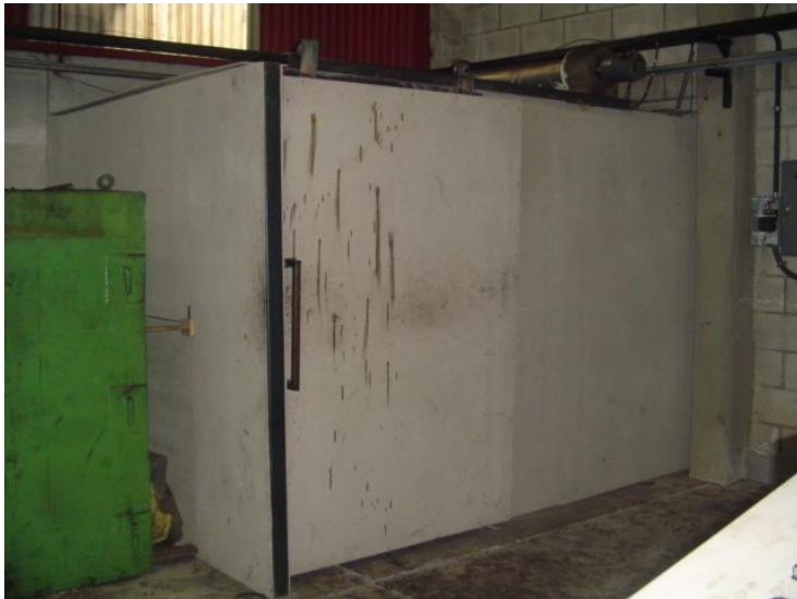
Figura 5. Horno para mantener temperatura del material
